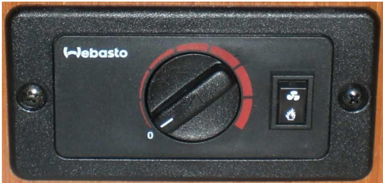
Mit dem Drehregler wird die Stärke der Lüftung/Heizung geregelt.
